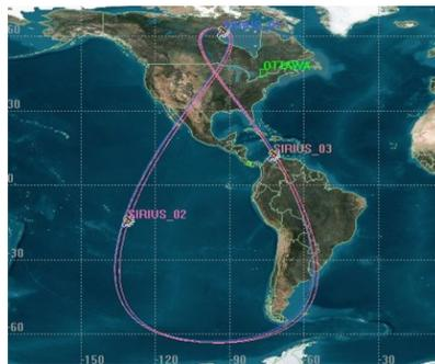
Abbildung 3: Bodenspur eines Satelliten (A4)
